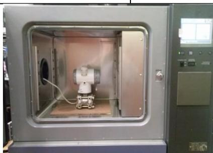
Рис. 4 - Датчик давления, установленный в температурной камере
