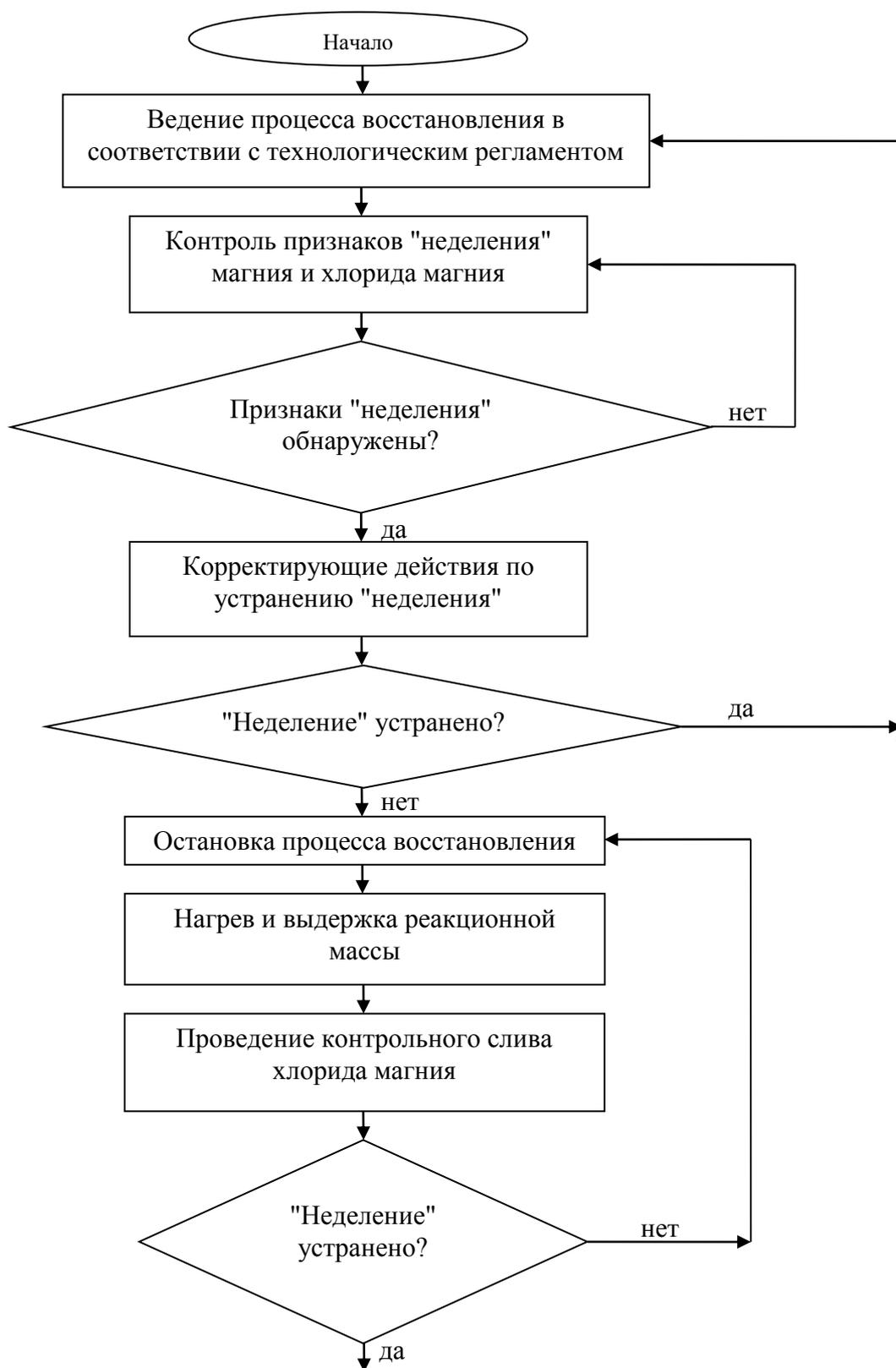
Рис. 2. Алгоритм управления расслоением магния и хлорида магния в аппарате восстановления
