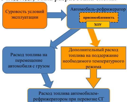
Рис. 1 - Механизм формирования расхода топлива автомобиля-рефрижератора при перевозке СГ
