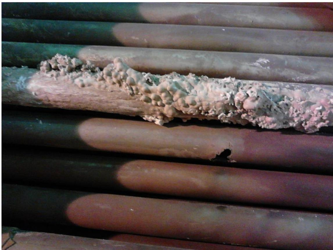
Рис. 1 – Отложения на внешней поверхности трубок теплообменника
