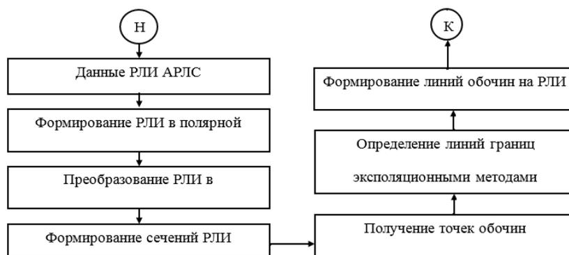
Рис. 1. Алгоритм вычисления положения границ дороги относительно АРЛС
