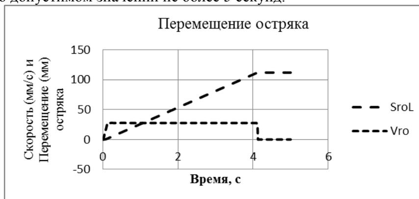
Рис. 3. – Значения скорости ( $V_{ro}$ ) и перемещения ( $S_{roL}$ ) рабочего органа остряка
