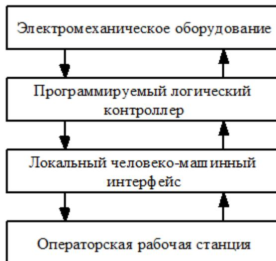
Рис. 1 – Структура автоматизированной системы сортировки багажа
