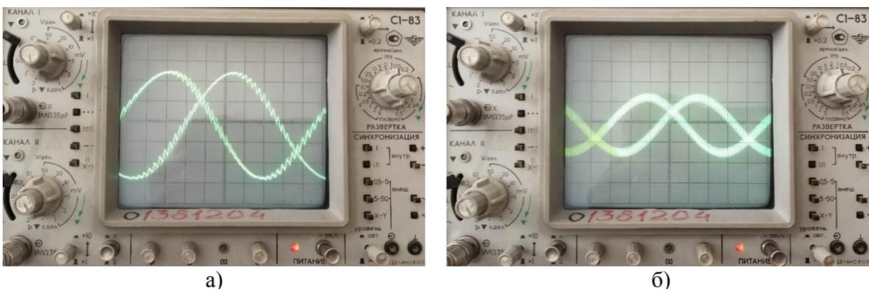
Рис. 3 – Сигналы фаз А и В 3-х фазного ШИМ-модулятора
