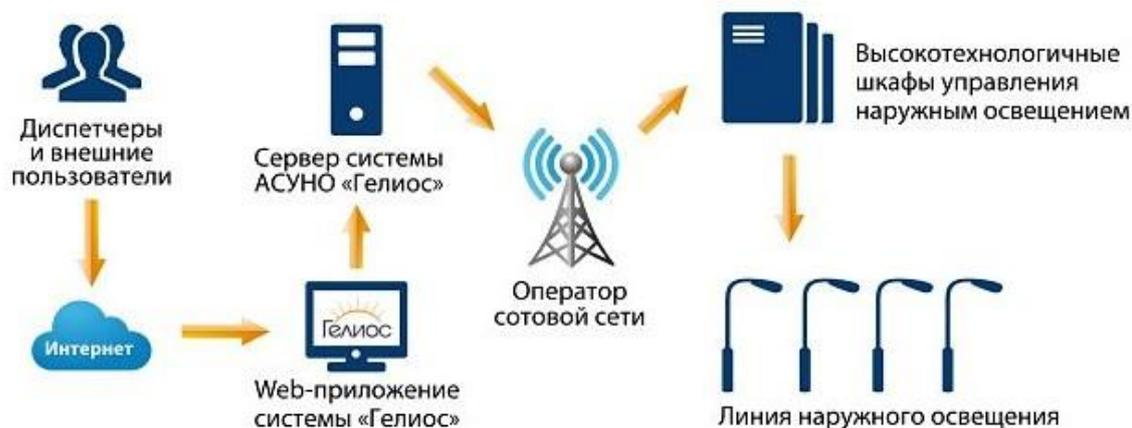
Рис.1. Общая схема работы системы управления
