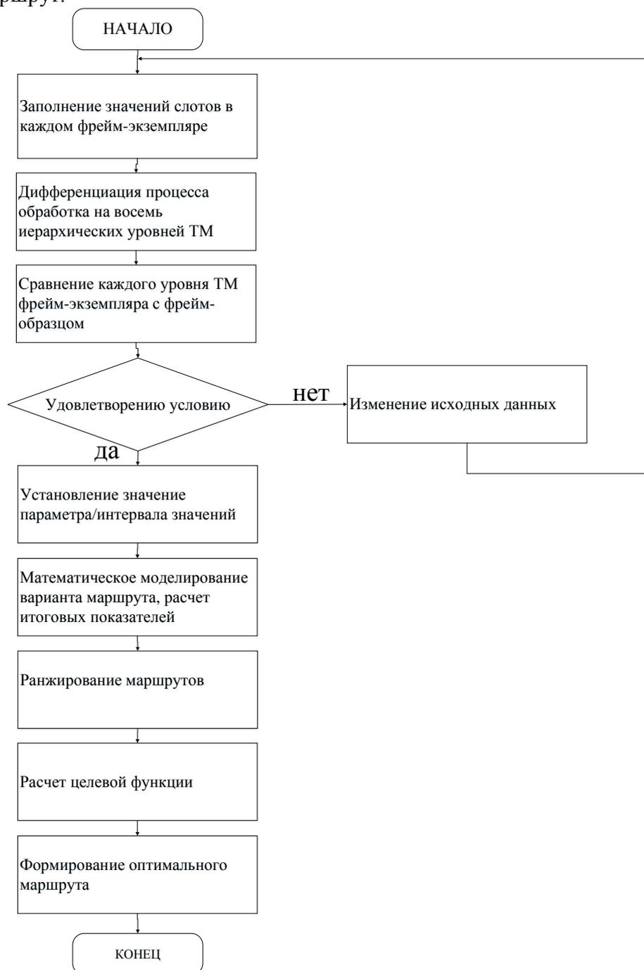
Рис. 2 - Алгоритм сравнения фрейм-экземпляра с фрейм-образцом и расчет оптимального маршрута
