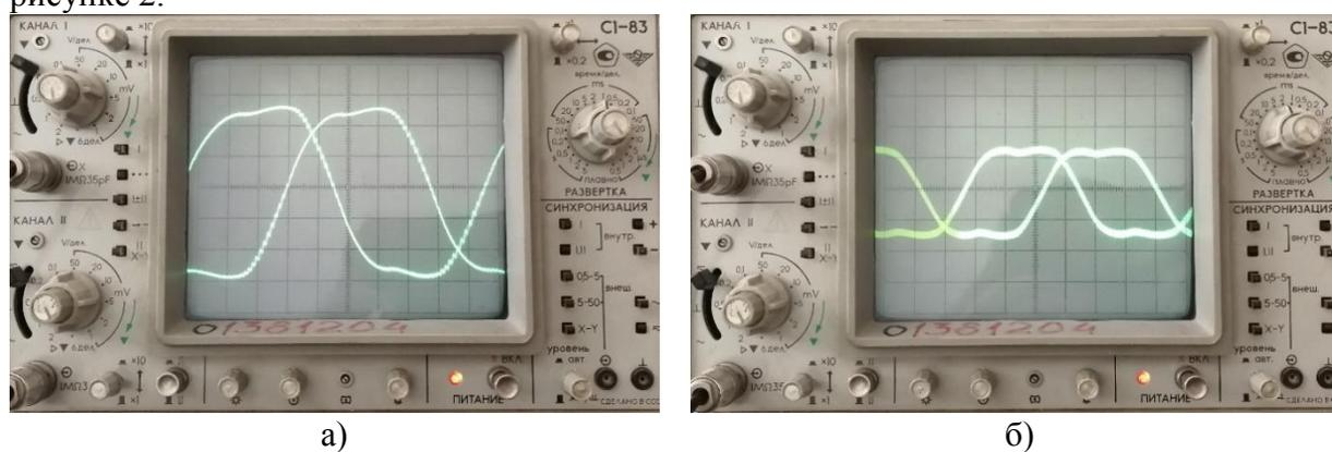
Рис. 2 – Сигналы фаз А и В 3-х фазного ШИМ-модулятора
