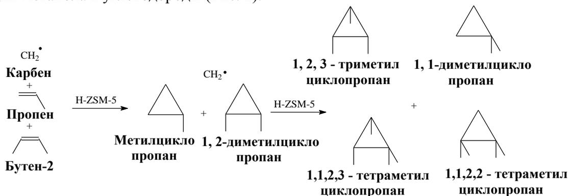
Рис. 2 - Схема образования триангуланов в процессе трансформации метанола
