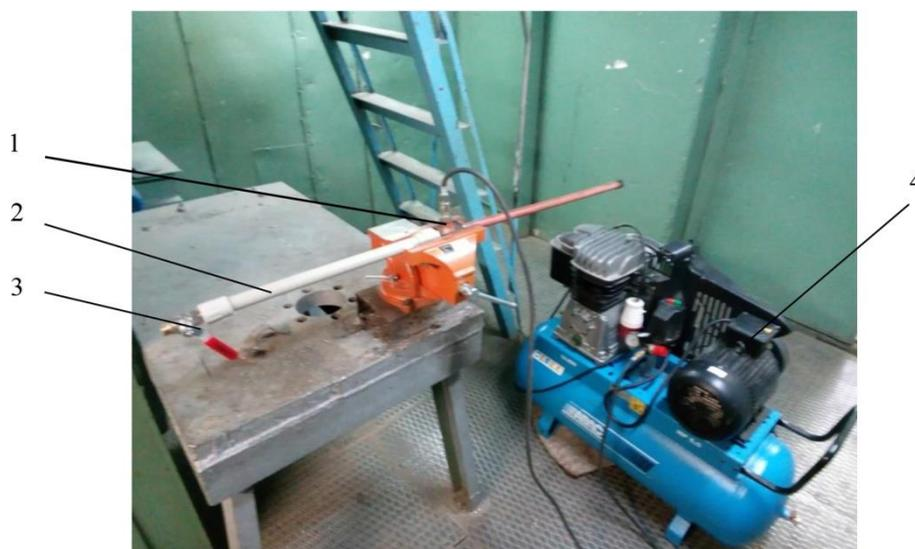
1- вихревая камера; 2- разделительная труба; 3- регулирующий клапан; 4- компрессор
