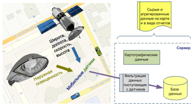
Рис. 1: Принцип действия мобильного датчика освещенности.
