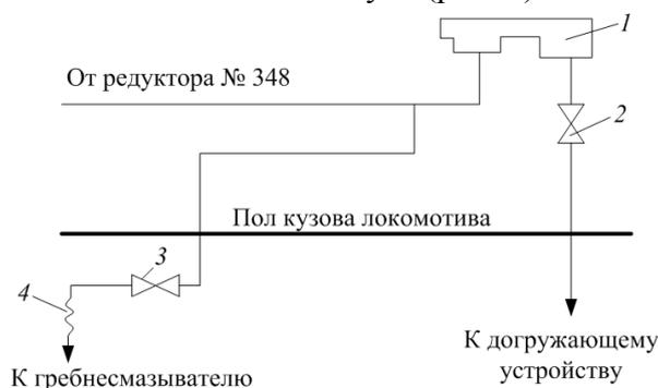
Рис. 2 – Схема пневмосистемы гребнесмазывателя:
