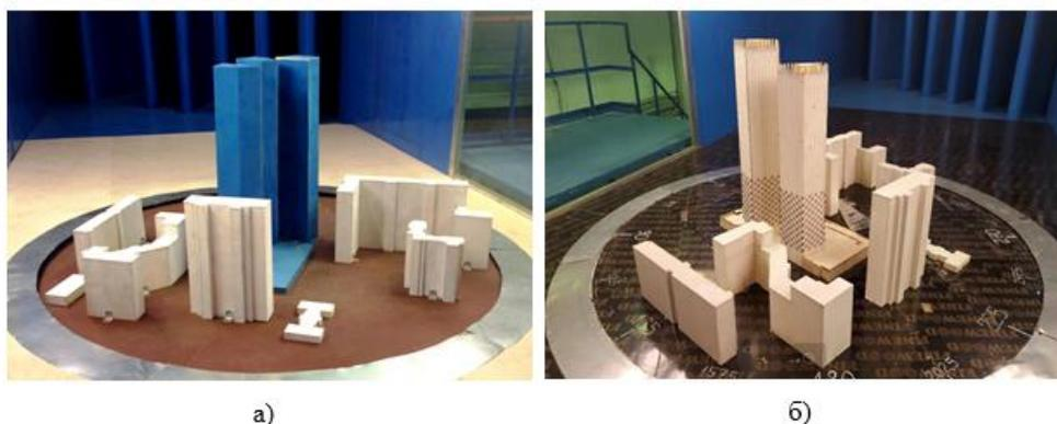
Рис. 2- Модель исследуемого объекта в рабочей зоне БИГАТ НИУ МГСУ
