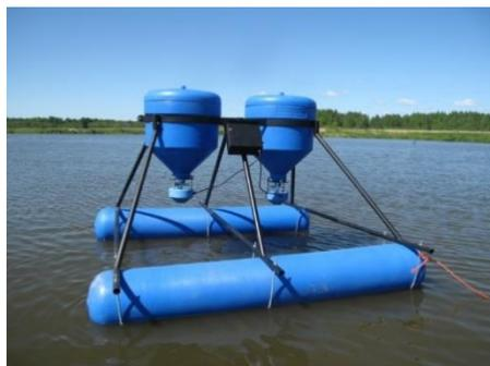
Рис. 1 – Автоматическая кормушка понтонного типа
