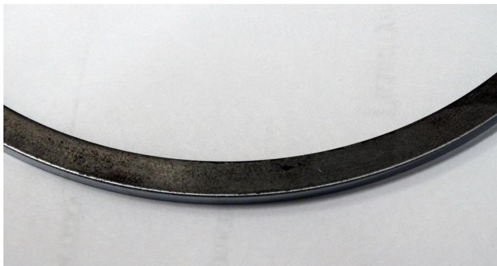
Рис. 1. Поршневое компрессионное кольцо со следами износа
