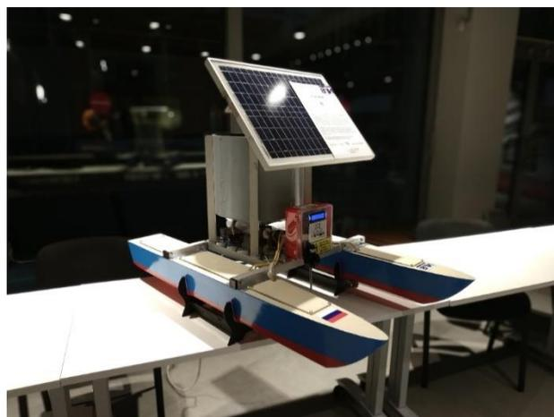
Рис. 3 – Опытный образец гелиокатамарана
