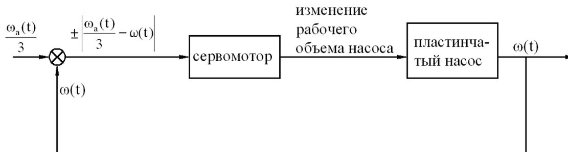
Рис. 2 - Функциональная схема САУ работой ветродвигателя роторного типа в режиме максимальной мощности
