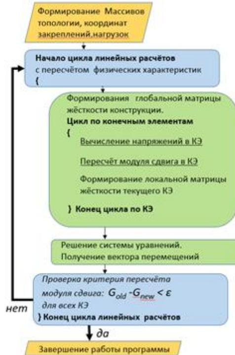
Рис. 1 – Алгоритм конечно-элементного расчёта грунтового массива с учётом физической нелинейности
