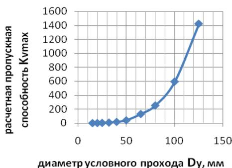
Рис. 2. Зависимость пропускной способности от диаметра условного прохода задвижки
