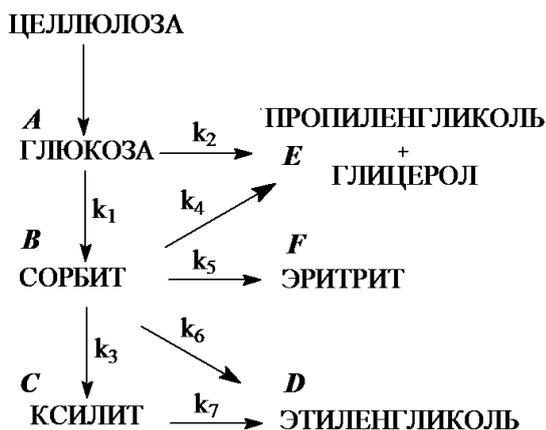
Рис. 1 Схема гидронолиза целлюлозы.
