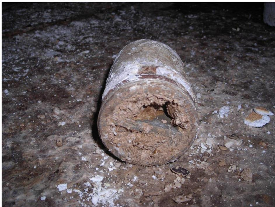
Рис.1 – Последствия процесса солеотложения на внутренней поверхности конденсатных труб РВКУ
