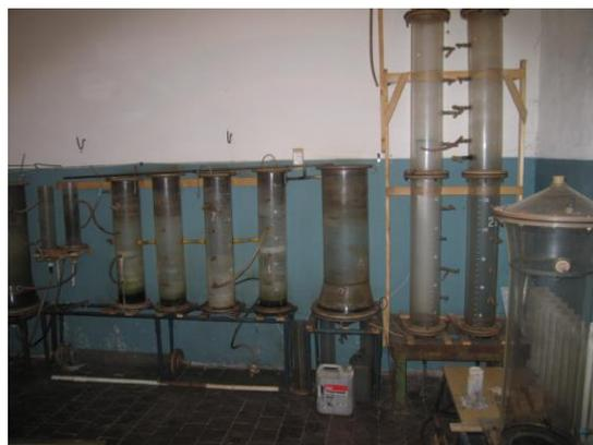
Рис. 2 - Лабораторная установка технологической схемы очистки.
