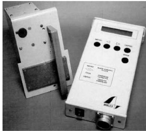
**Рис. 2 – Прибор для измерения проката и толщины гребня**
