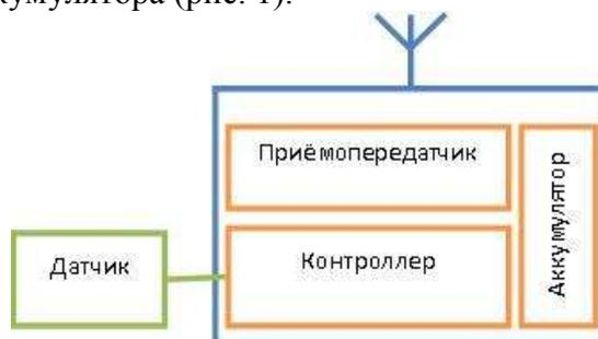
**Рис. 1 – Структурная схема беспроводного датчика.**
