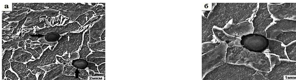
Рис. 3 – (а) СЭМ-изображение столбчатой зоны шва, (б) более высокое разрешение изображения включений по (а)
