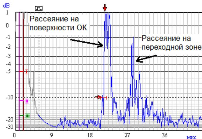
Рис. 2. Типичный А-скан рассеяния ультразвука на переходной зоне
