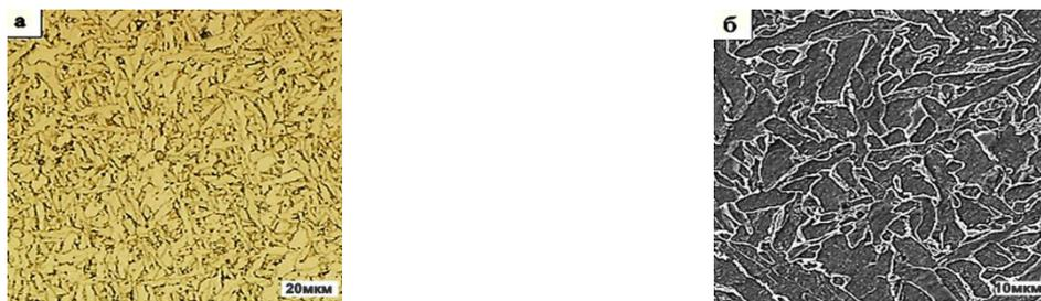
Рис. 2 – (а) изображение столбчатой зоны шва и (б) СЭМ-изображение, показывающий размер и распределение Ti-содержащих включений
